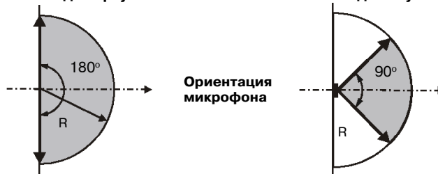
Рисунок 2 – Диаграмма зоны обнаружения АК канала
